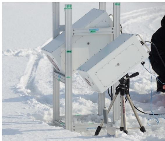
図 2 観測中の MMRS の写真。奥側が 6GHz, 手前側が 36GHz.
