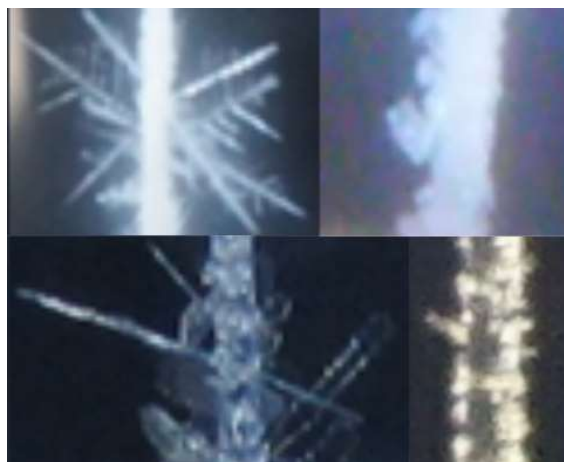
図2 スネイクカメラで観察された結晶画像例(左上:樹枝状, 右上:扇状, 左下:星状, 右下:針状)。釣り糸の直径は約0.3 mm.
