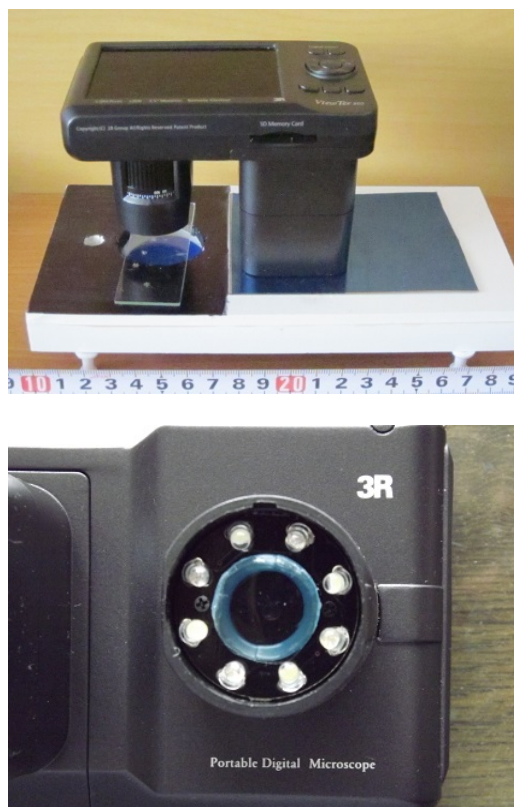
図2 携帯型顕微鏡の概観（上）とレンズ及びその周囲の照明用LED（下）。上図の下端はスケール。
