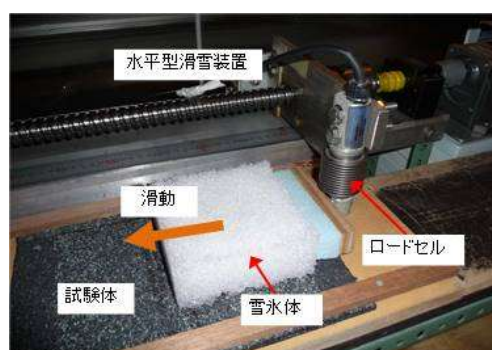
図2 動摩擦係数の測定方法
