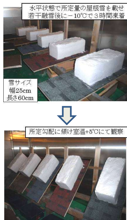
図4 雪止め機能評価試験の実験方法
