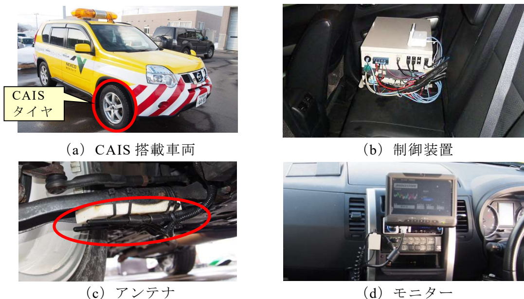
図3 雪氷巡回車へのCAIS搭載状況
