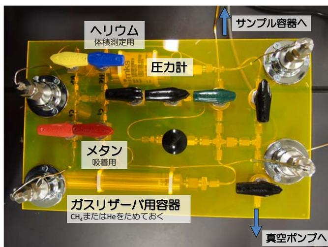
図1 積雪比表面積測定装置 (4号機)
