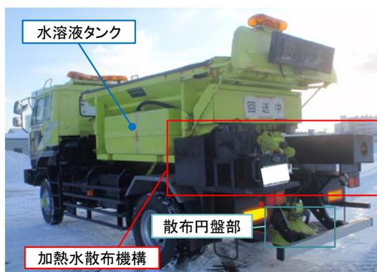
図 2 試作した加熱水散布機構
