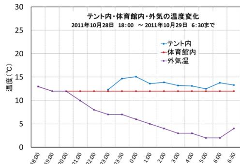
図-5 外気温(下), 体育館内気温(中), テント内気温(上). (23:00 に煉瓦搬入)
