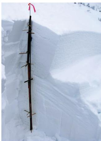
図 3 破断面を含む積雪断面
