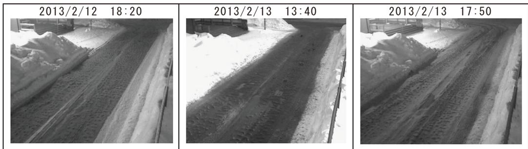
図9 2013/2/12~13 のこぶ氷の成長（静止画像記録装置による定点観測結果より）
