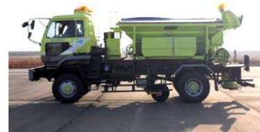
図2 凍結防止剤散布車 (4.0m<sup>3</sup>級, 湿式)
