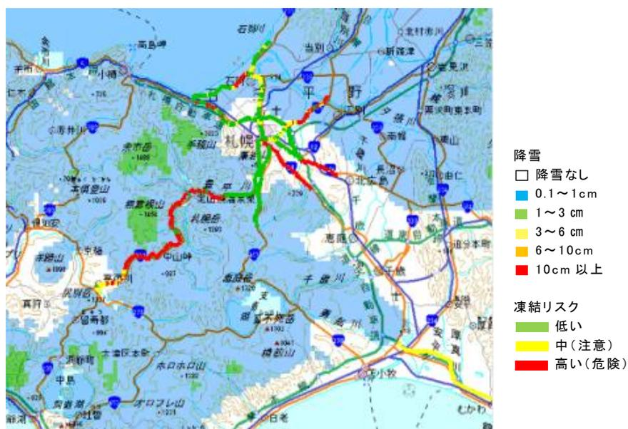
図1 寒地土木研究所版路面凍結モデル
