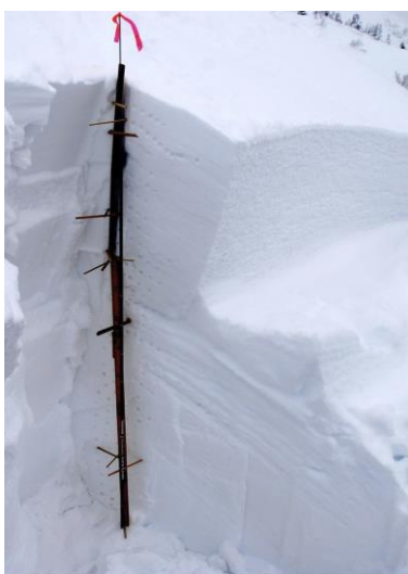
図 3 破断面を含む積雪断面 模式図中の赤および黄で示した新雪・こしまり雪層が弱層となった。
