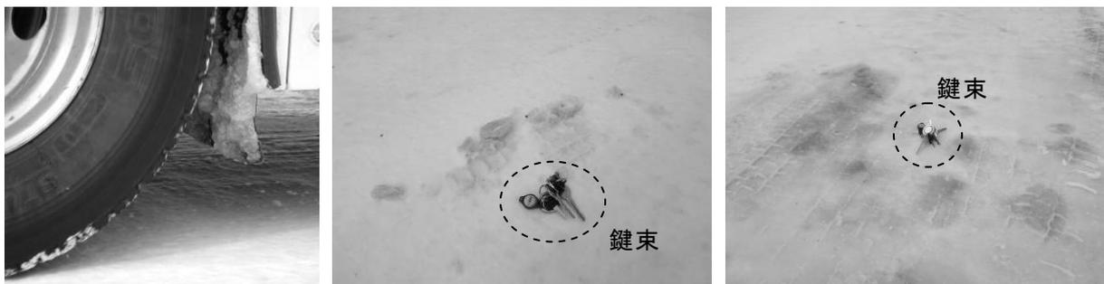
図-7 タイヤボックス(左)から圧雪上に落下した雪塊(中)と踏まれてできたしみ(右)
