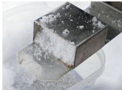
図-3 標準型密度サンプラーの外枠をはずした直後の状況
