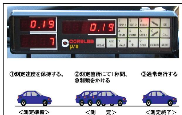
図-2 加速度計（上）と測定原理
