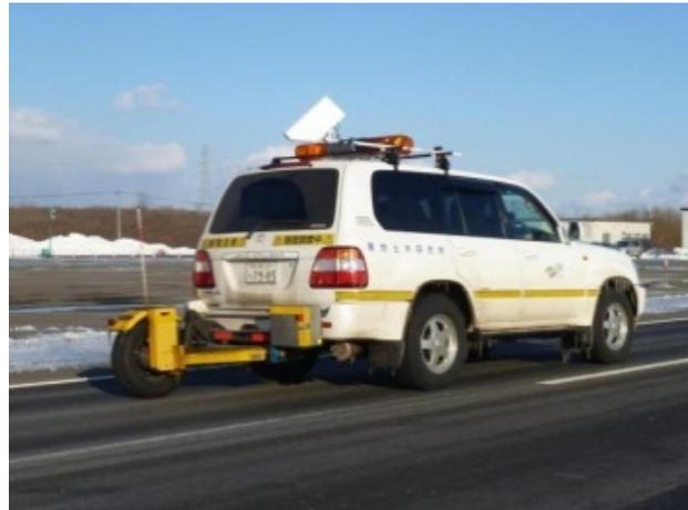
図-3 CFT・IR 搭載試験車
