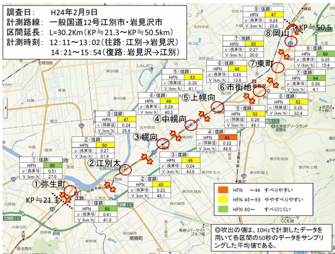
図-5 路面すべりモニタリング調査結果
