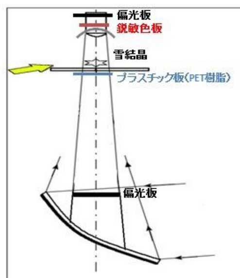
図-3 雪結晶の顕微鏡写真撮影装置。偏光板二枚は直交。
