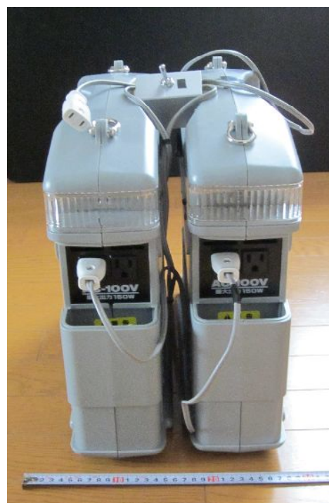
図-2 二個の蓄電池と切替器。
