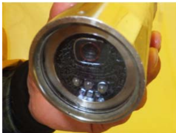
図-3 S-type カメラを LED 照明とともに耐圧容器に収めたところ
