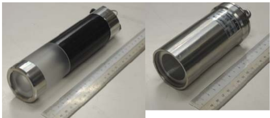
図-2 P-type 用耐圧照明ハウジング (左) と S-type 用耐圧容
