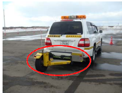
図-2 連続路面すべり抵抗値測定装置(CFT) (左) すべり抵抗値の測定原理 (右)
