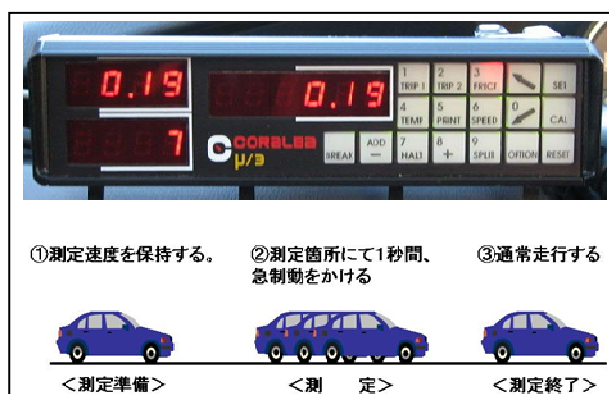
図-2 加速度計（上）と測定原理
