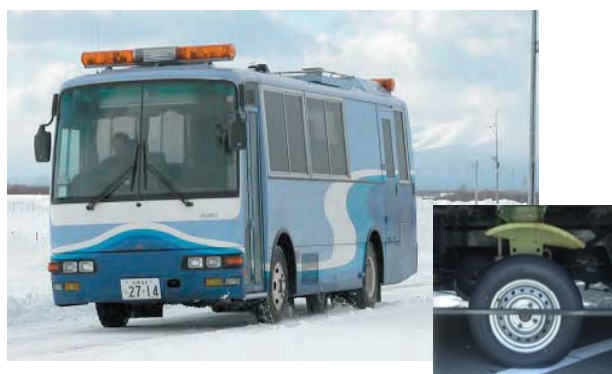
図-1 路面すべり測定車
