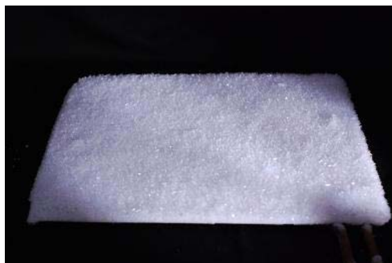
図-3 アルミ板に生成された表面霜
