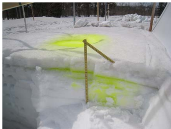
図-6 積雪層境界における水平方向の水の流れ（蛍光染料散布）
