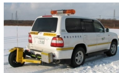
図-6 連続路面すべり抵抗値測定装置 (CFT)
