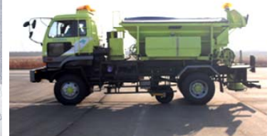
図-4 凍結防止剤散布車 (4.0m 3 級, 湿式)
