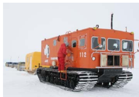
図-2 大型雪上車 (SM100S 型) と幌橇. 雪上車に牽引されている黄色い幌橇内部に加速度計を設置した.
