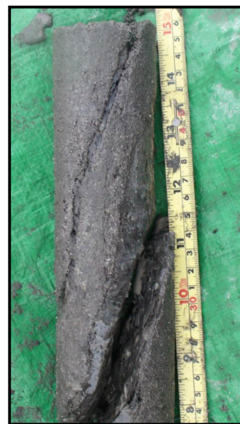
図4 五色サイト10mボアホール約8m深で採取された凍土コア。斜めに走る割れ目は透明の氷で充填されていた。
