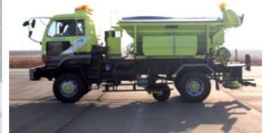
図-4 凍結防止剤散布車 (4.0m 3 級, 湿式)
