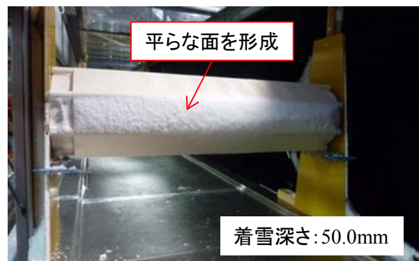
写真2 膜材料を円柱部材に巻きつけた場合の実験結果
