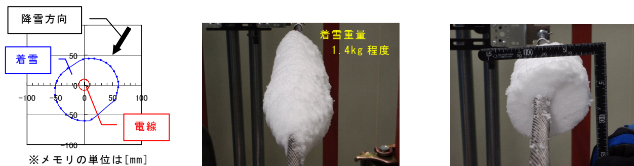
図-3 計算結果による着雪形状断面図と着雪状況 (左: 計算値, 中央: 実験値②[全体], 右: 実験値②[断面])
