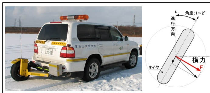
図-3 CFT 外観（左）と測定原理（右）
