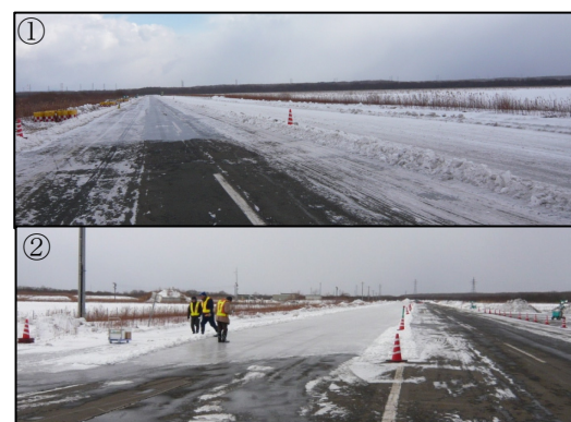
図-4 苫小牧寒地試験道路実験状況 ①の左上は氷膜で散水後凍結した状態．散水直後は湿潤状態．①の左下は乾燥．①の右上は圧雪．②の左は氷板で散水，凍結を繰り返すことで作製．
