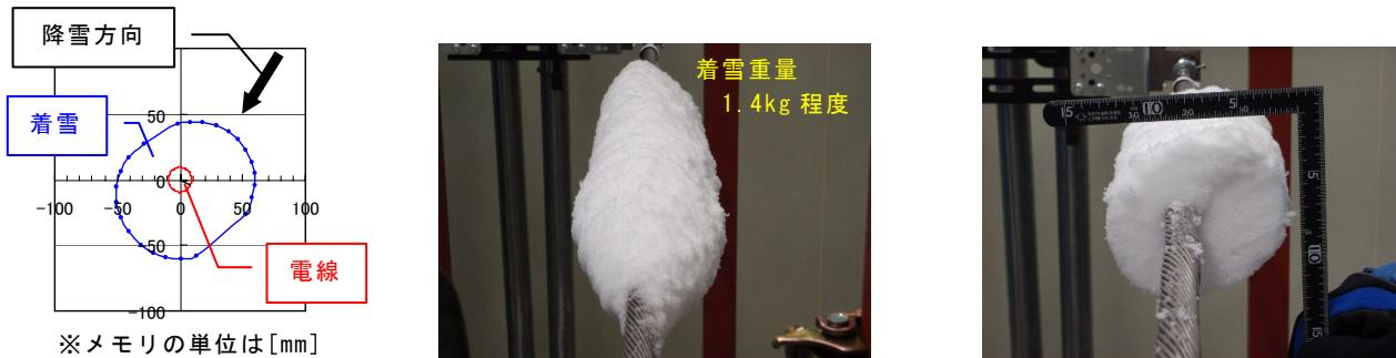
図-3 計算結果による着雪形状断面図と着雪状況
