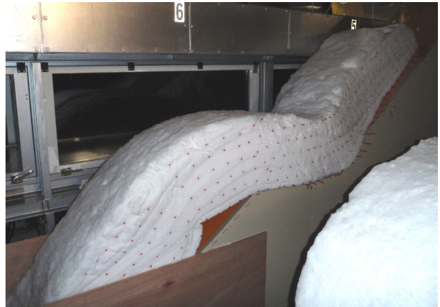
図 6 4 分の 1 スケールの道路小段模型上での積雪の移動状況 . 小段上で積雪を支持しきれず, 滑動が発生した .
