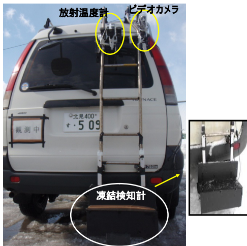
図4 凍結検知計. 左: 車両後部に取り付けられた検知計, 右: 検知計を下側からみた様子.
