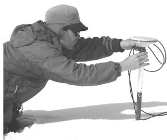
図 4 流動速度測定に用いた測量ポールと GPS アンテナ
