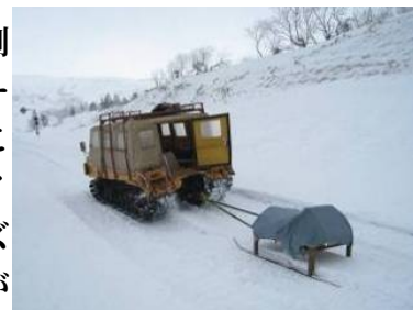
写真2 雪上車による GPR 搭載ソリ牽引風景
