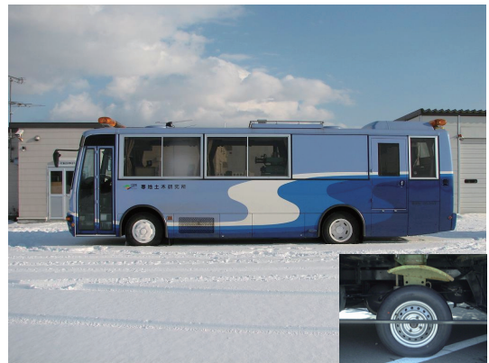
写真 1 バス型すべり試験車
