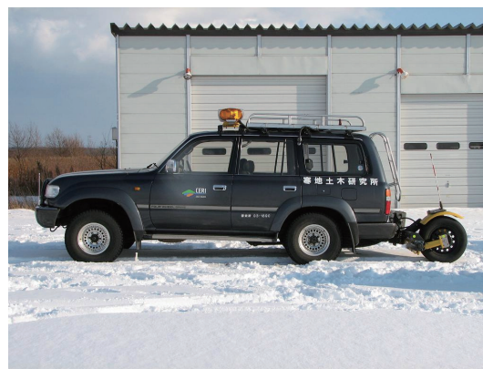
写真 2 連続路面すべり抵抗値測定装置
