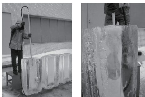
図4 氷塊 ( 1 \times 0.5 \times 0.25 \text{ m}^3 ) を用いた掘削試験
