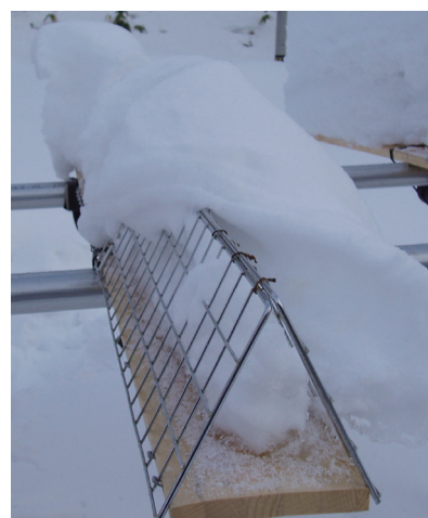
写真 9 △フェンス上の冠雪の剥離
