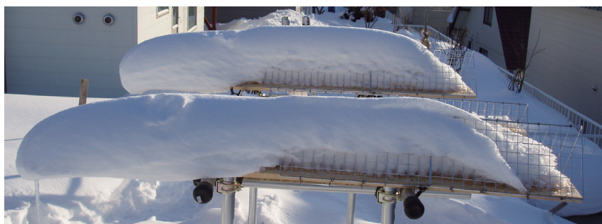
写真 7 三角格子フェンスの実験状況
