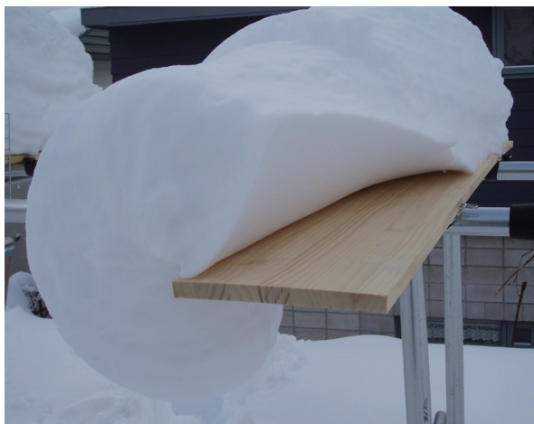
写真6 偏荷重による雪庇の剥離
