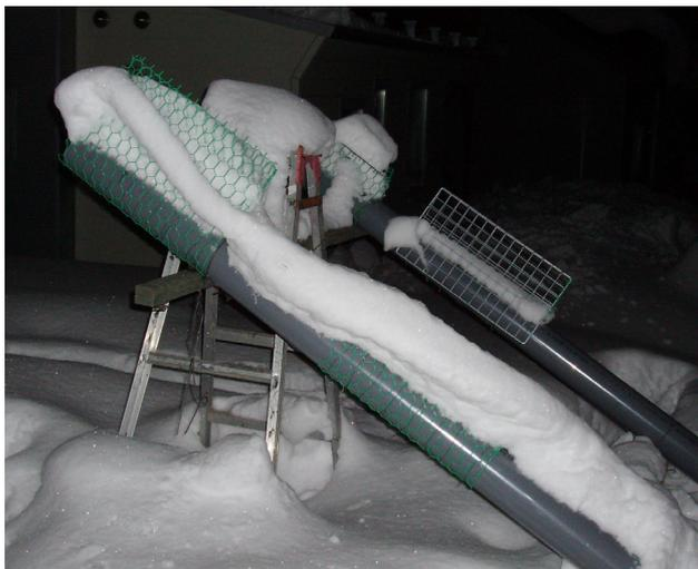
写真4 斜材（塩ビパイプ）の側面にできた紐状冠雪
