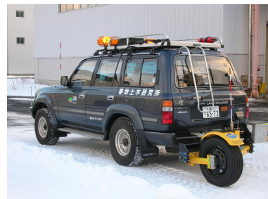
写真-1 連続路面すべり抵抗値測定装置
