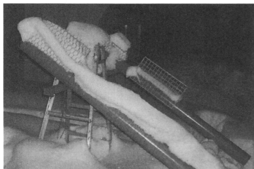
写真2 実験状況、斜材の傾斜角は30° (1/9 21:05)
