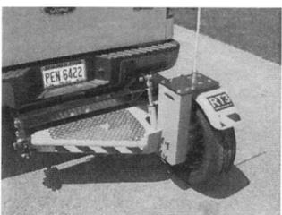
写真-13 凍結防止剤散布車に取付可能な連続摩擦係数計測装置(RT3)
