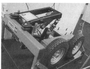
写真-11 車両牽引式連続摩擦係数計測装置(TWO)
