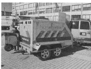
写真-10 車両牽引式連続摩擦係数計測装置(RoAR MkⅢ)
