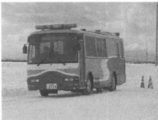
写真-1 路面すべり測定車
