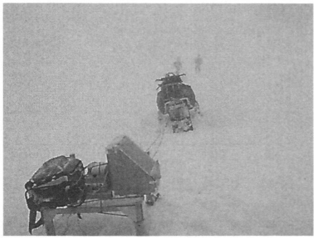
図 10 知床峠観測風景。 (そりの上に GPR を搭載してある)
