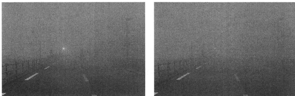
図6 霧内での視線誘導設備の視認性評価の一例 (昼間、視程約50m、左写真：光度3000cd、右写真：光度300cd)
