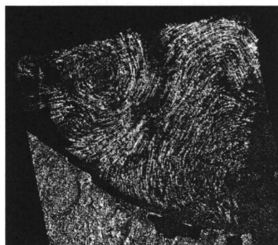
図3 RADARSAT SAR(1998/02/24 17:25-25 05:36)による海氷移動解析。
