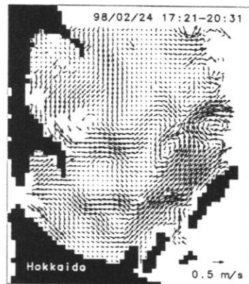
図2 NOAA/AVHRRによる海水移動解析。 (観測間隔:3時間)
