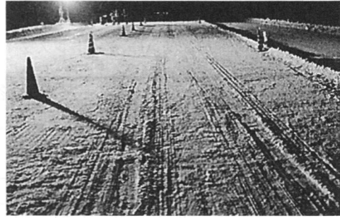
写真-4 延べ50台走行後の路面 (スパイクタイヤ20%混入)
