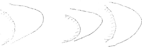
図-7 着雪断面形状の一例 (左:ACSR、右×2:捻回楕円電線)
