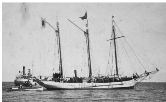
図 1 第一次航海時（左）と第二次航海時の開南丸。開南丸は木造三檣スクーナ船で、第一次航海では通常のスクーナ型縦帆を用いていたが、南極海では一般に風が強く、また操帆が容易なことから第二次航海では三角帆に変更した。（白瀬南極探検隊記念館より提供）
