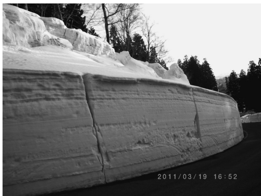
図 19 道路脇の堆雪に入ったクラック。積雪底面まで到達しているが, 地面にはクラックは見られなかった(新潟県十日町市)。
