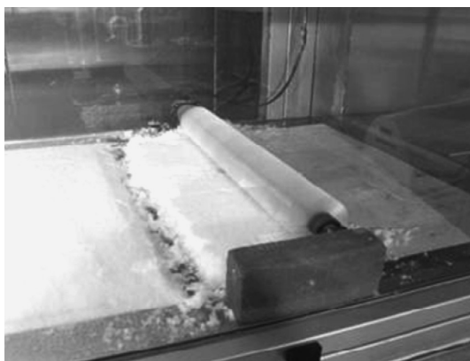
図 2 吹雪粒子供給装置 回転ブラシによって雪粒子を空気中に舞い上げ、人工吹雪を発生させる。
