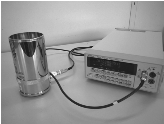
図 3 電荷測定に用いたファラデーケージ (左) とエレクトロメーター (右).
