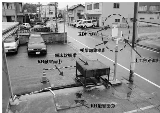
4極センサーによるロードヒーティングの省エネ制御実験(橋梁模型)
