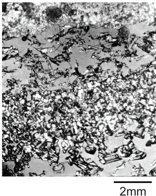
図 8 1997 年 1 月 30 日における降雪結晶弱層 a の鉛直断面のアニリン薄片。ややクラスト化したこしもぞらめ雪の層に挟まれた、層厚約 2 mm の降雪結晶による低密度層が明らかである。なお、最下層の骸晶は前述のしもぞらめ弱層。
