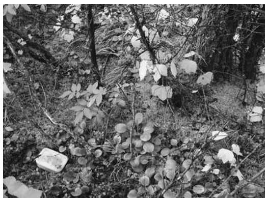
図 4 地温計. 密閉プラスチック容器で防水している.
