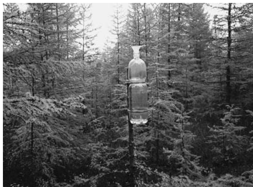
図 5 簡易降水量計. ここではロシア製 1 L のペットボトルを使用した.
