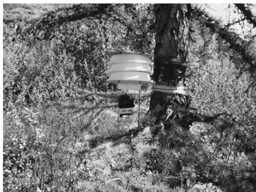
図 3 気温計. 北見工大作成の自然通風式シールドが付いている.
