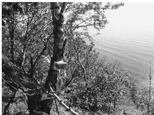
図 8 カメラ機能内蔵のデータロガー. 盗難などを避けるため樹木と同じ色彩にしている.
