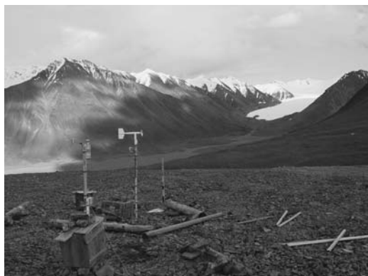
図 7 日射計と風向風速計. ここには気温計 (Pt100 と KADEC-US, コーナーシステム), 簡易降水量計, 積雪深計, カメラ機能内蔵データロガーも設置している.
