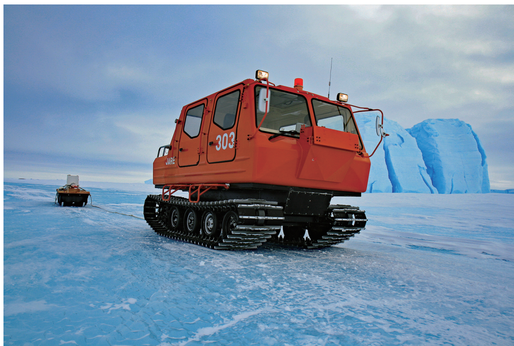
写真 1 海氷観測に利用した SM30 と橇牽引式の電磁誘導 (EM) 法氷厚観測システム.
