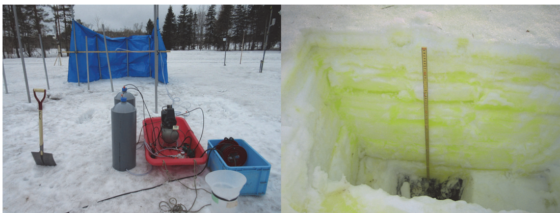
写真 2 北海道大学低温科学研究所母子里融雪観測室露場における模擬降雨散水実験の様子 (石井吉之撮影).
