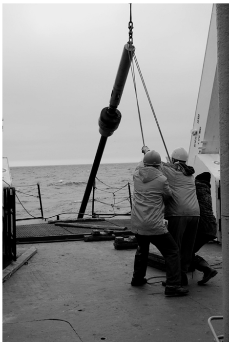
写真 4 天然ガスハイドレート入りの海底表層堆積物コア採取に用いられるコアラー。
