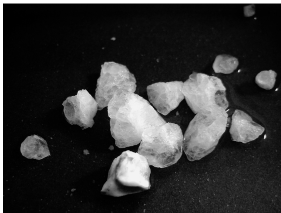
写真 5 バイカル湖南湖盆の Bolshoy 泥火山で採取された、ほぼ透明な天然ガスハイドレート結晶（粒径は 4 mm～8 mm 程度）。
