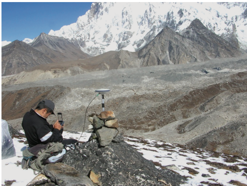
写真 2 氷河の脇の測量基準点での GPS 測定の様子
