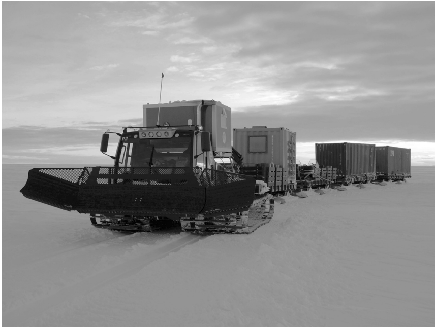
写真 3 Pisten Bully に牽引された大型橇 4 台の旅行隊列。最初の 2 つの橇には橇の半分を占める居住用キャビン（灰色）、ドラム缶、スノーモービル等が搭載されている。後ろの 2 つの橇には海上輸送用コンテナが積まれており、この中に観測機材やキャンプ用具などが保管されている。
